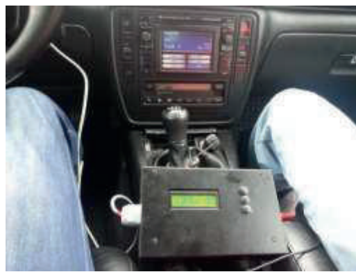
Slika 2. Punjenje uređaja vrši se preko auto punjača
