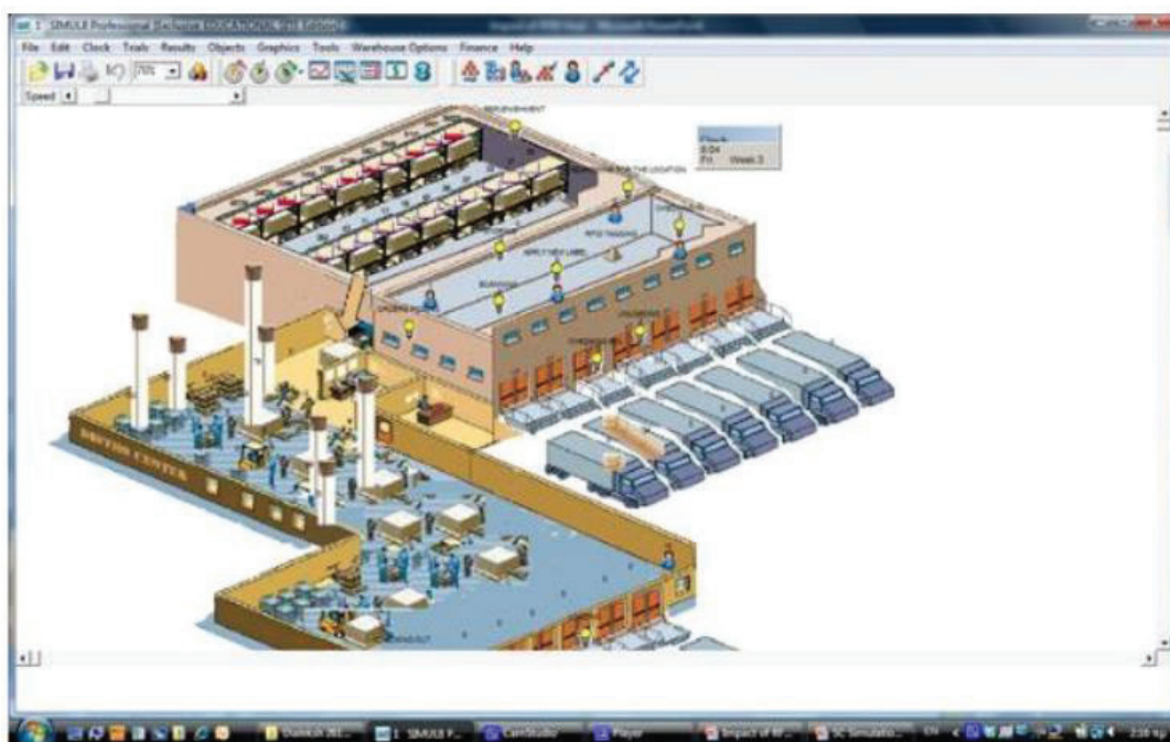
Slika 5. Prikaz simulacije skladišta u softveru SIMUL8
