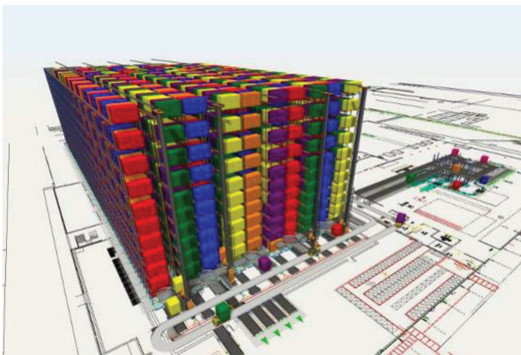
Slika 5. Prikaz 3D simulacije skladišnog prostora u FlexSimu 3
