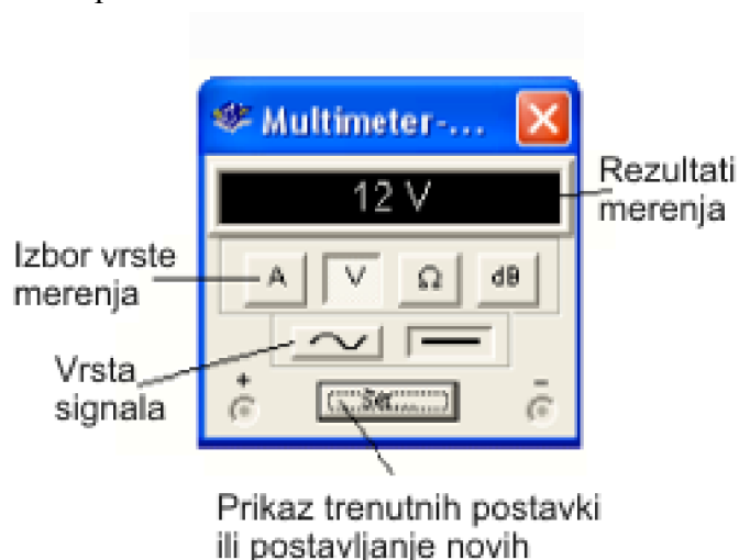
Slika 7. Prikaz multimetra koji radi kao voltmetar
