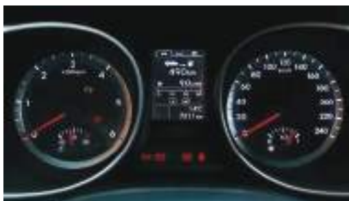
Slika 4. Uobičajena lokacija za MIL lampicu na instrument tabli vozila
