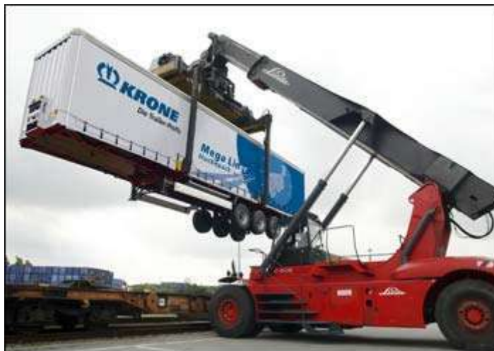
Slika 4. Huckepack tehnologija – Utovar drumskih vozila na željezničke vagone
