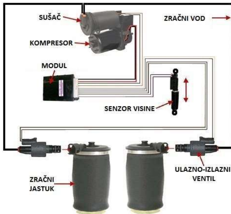
Slika 1. Princip rada zračnog ovjesa
